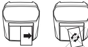
**! Bei falscher Zuführung der Banknote wird diese als verdächtig eingestuft und mit einer Fehlermeldung quittiert.**
