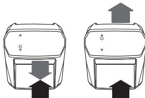
**!** Мы рекомендуем использовать режим прямой подачи при проверке пачки банкнот. Обратная подача удобна при работе с отдельными банкнотами или в условиях ограниченного пространства (например, при размещении детектора у стены).
