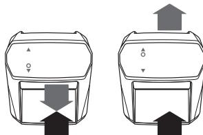
**!** Wir empfehlen bei größeren Banknotenmengen den Gebrauch der Ausgabe „vorwärts“. Dies beschleunigt die Überprüfung. Die rückwärtsartige Banknotenausgabe ist komfortabel bei gegebenen Platzmängeln des Kassierers (z. B. Das Banknotenprüfgerät muss direkt an der Wand platziert werden).
